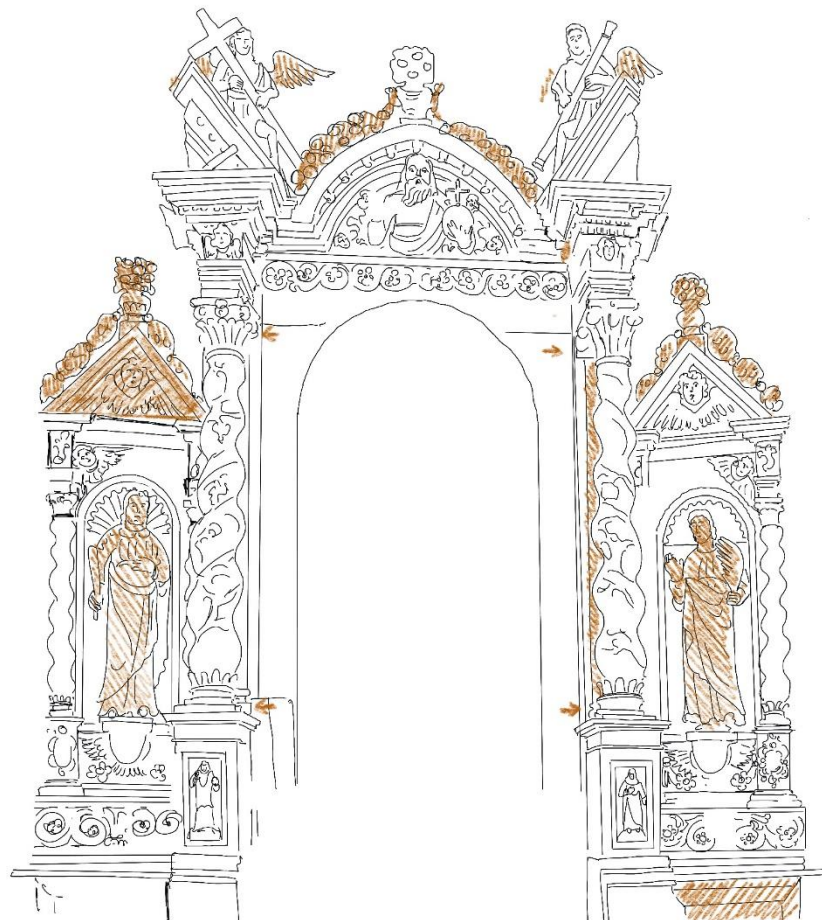
Localisation des parties déposées et traitées en atelier.
